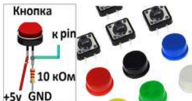
Рис. 1. Схема подключения тактовой кнопки к микроконтроллерной плате
